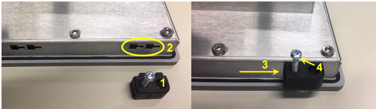
Abbildung 5: Montage in der Schaltschrankfront für Panels bis 7" Displaygröße
